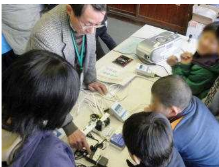
待機電力を測定する実験。スイッチを切っても電気が流れている
