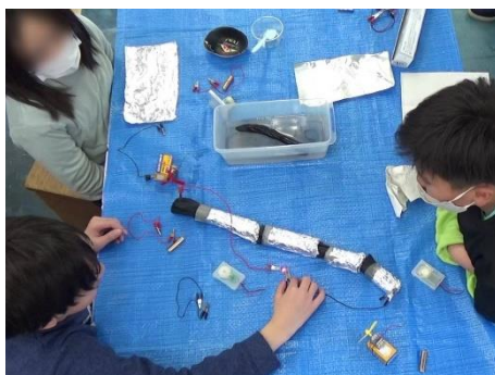
備長炭電池を直列接続してLEDを点灯する
